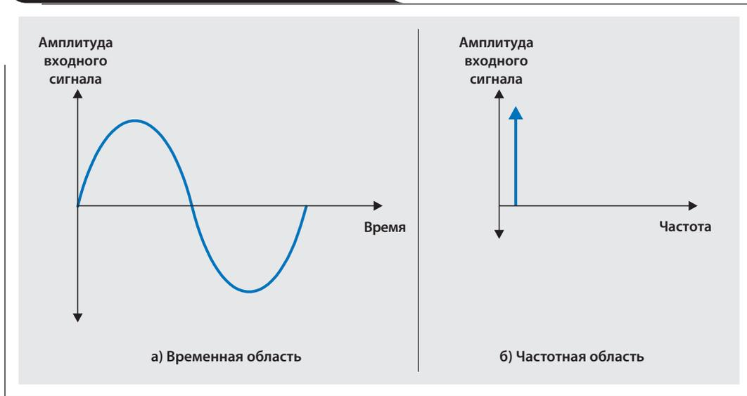
На Рис. 2а показан один период синусоидального сигнала, подаваемого на вход  $\Delta\Sigma$ -модулятора. Как видно, амплитуда сигнала изменяется с течением времени. На Рис. 2б тот же сигнал изображён в частотной области. График на Рис. 2б соответствует непрерывному синусоидальному сигналу и представляет собой вертикальную линию (пик).
